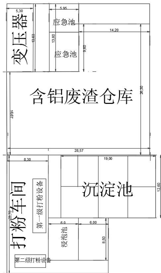
图 4.1-9 废渣仓库、打粉车间整改方案
