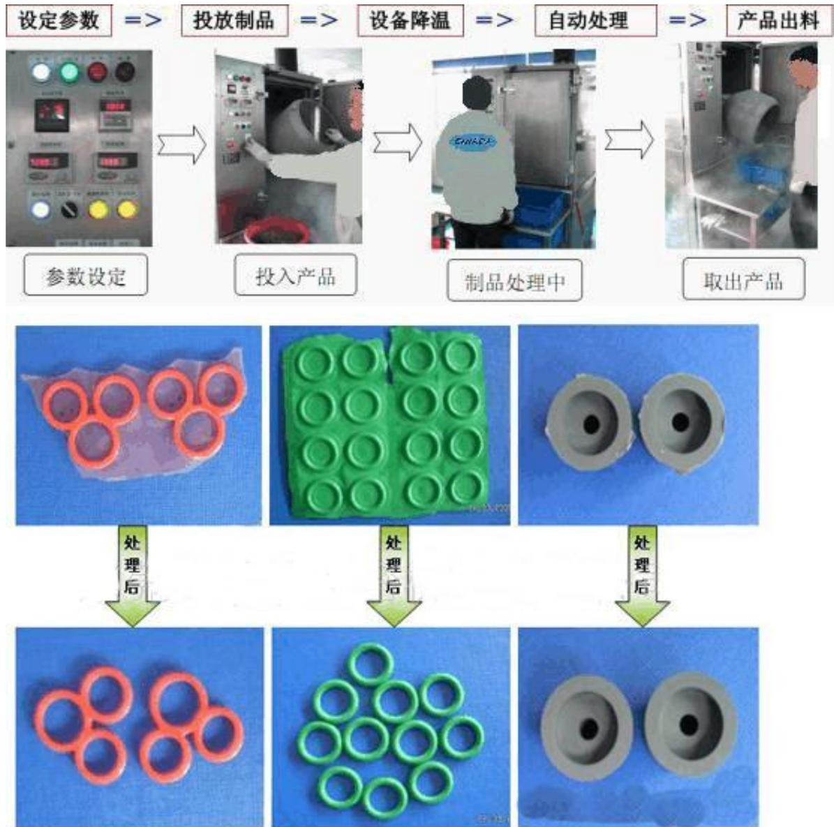
图 5-2 冷冻去毛边流程图
