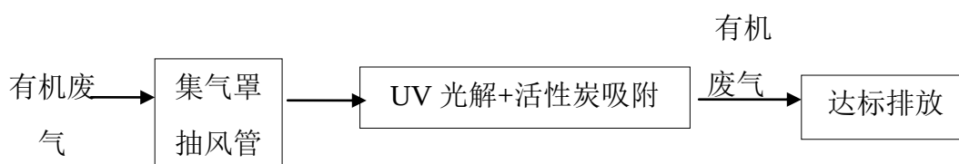
图 7-1 集气罩收集 UV 光解+活性炭吸附装置处理工艺流程图
